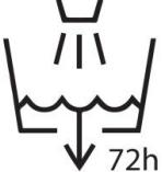
**Meios: Limpar o depósito de água de três em três dias.**
